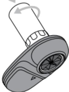
Vložte novou turbínku – zasuňte ji do přístroje.
